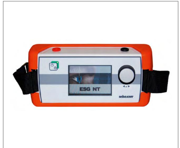
ESG NT имеет контрастный цветной дисплей. Измеренное шаговое напряжение может быть представлено в двух вариантах: в виде гистограммы (аналог традиционному стрелочному прибору) и в виде общей “индикации-истории”, которая представляет реальное направление и последние 5 - 6 результатов измерений. Таким образом четко и постоянно отображаются все изменения. „Направление по отклонению стрелки“ всегда указывает путь к повреждению.
