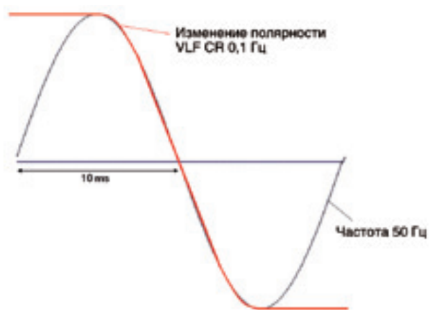
Изменение полярности косинусно-прямоугольной формы напряжения СНЧ
