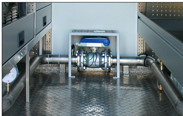
TDM 200 встроен в измерительную лабораторию.
