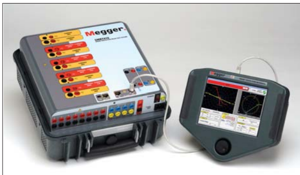
Сенсорная панель STVI с устройством SMRT410
