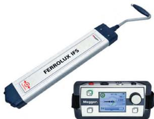
Ferrolux Rx приемник звуковой частоты с датчиком трассы IFS объединяет своими методами локализации SuperMax, SignalSelect (определение направления сигнала) и уже зарекомендовавшим себя методом звуковой частоты множество функций для точной локализации трассы и повреждений кабеля в одном приборе.
