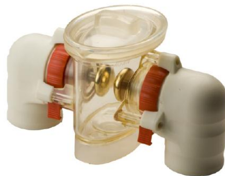
Ячейка объемом 400 мл в сборе (электроды вставлены)
