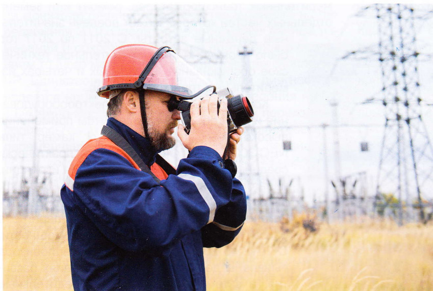
Тепловизионный контроль ВЛ 110 кВ
