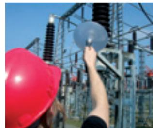
**Испытания на открытом воздухе с помощью параболического акустического приемника.**
