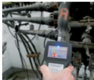
**Online измерения ЧР в кабеле среднего напряжения с помощью датчика HFCT.**
