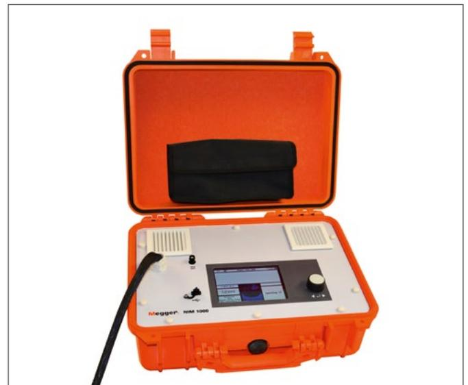
При помощи NIM 1000 можно провоцировать возникновение повреждений, например, повреждение нейтрали, плохие контакты и зависимые от нагрузки повреждения, которые после этого, при необходимости, можно предварительно локализовать подключенным в это время измерительным прибором.
