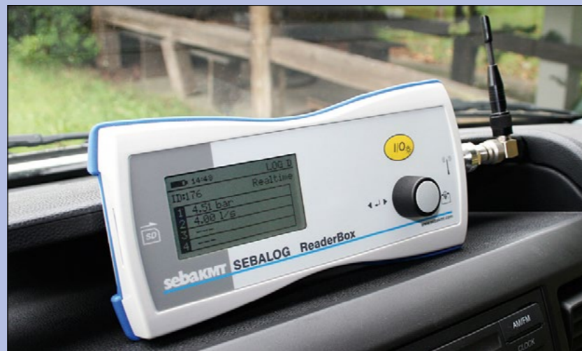
Reader 3 при Online-измерении логгером Sebalog Dx.
