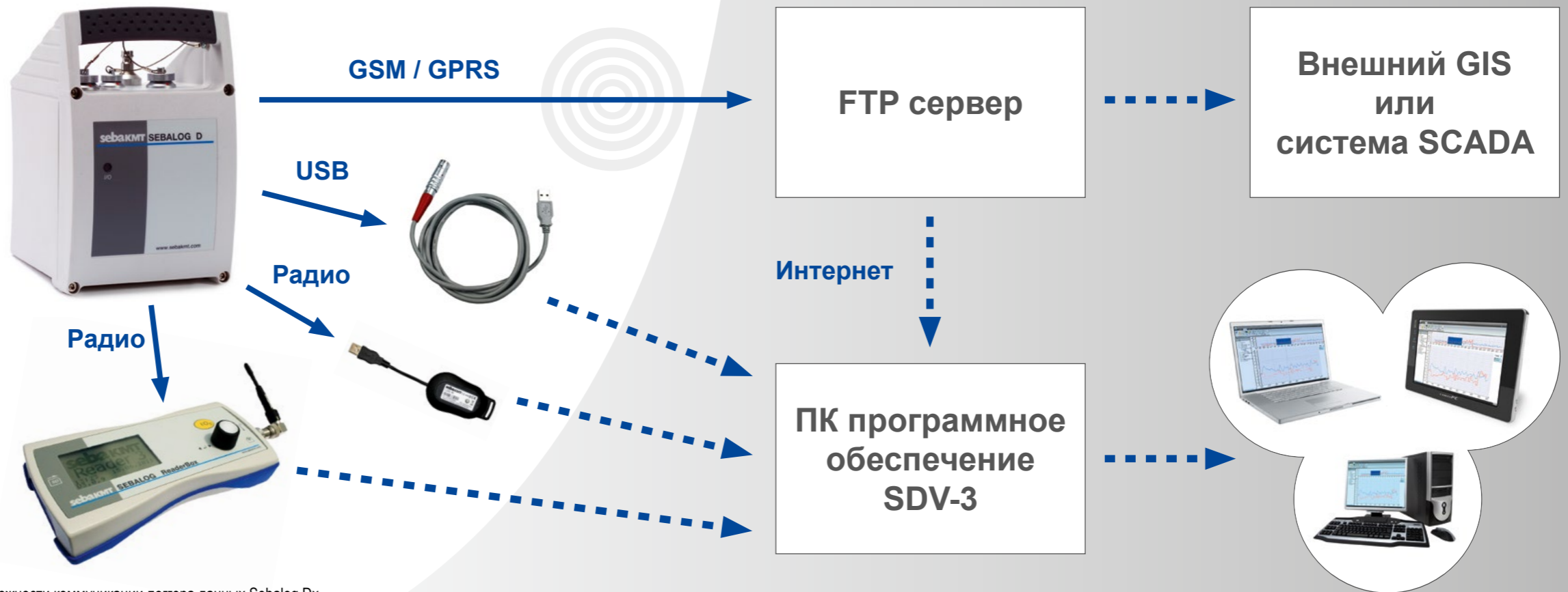
Возможности коммуникации логгера данных Sebalog Dx.
