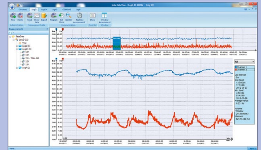
Блок данных за несколько дней (измерение расхода и давления).
