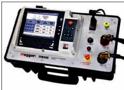
Специально разработанные тестовые провода с соединением под прямым углом и крупными зажимами обеспечивают гибкость, необходимую в холодную погоду.
