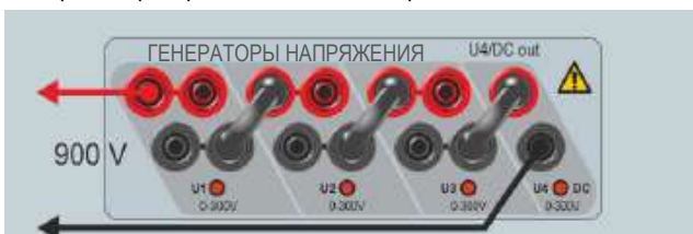
Все четыре генератора напряжения включены последовательно.
