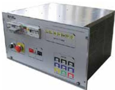
Блок управления NSF-13 с трехфазным высоковольтным переключателем предназначен для автоматического управления блоками электротехнической лаборатории «Русич». Автоматический трехфазный переключатель предназначен для коммутации высоковольтных и низковольтных сигналов с выходов испытательных установок и приборов к трем фазам испытуемого силового кабеля. После проведения испытаний и измерений все фазы силового кабеля автоматически заземляются.
