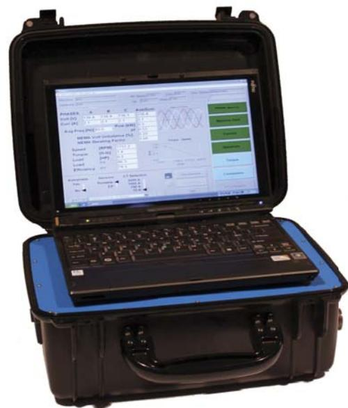
Программа, заложенная в них, выдает информацию об уровне напряжения, балансе напряжений, нелинейном и полном искажении, состоянии ротора, производительности двигателя, эксплуатационном коэффициенте полезного действия, уровне перегрузки потока, рабочем состоянии, изменениях крутящего момента, нагрузке в сопоставлении с другими двигателями и т.д. Все эти данные в совокупности позволяют определить истинное состояние электродвигателя и условия, влияющие на производительность двигателя.
