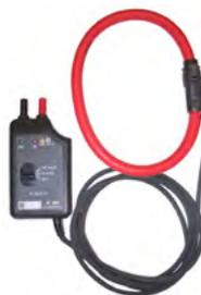
Гибкие передающие клещи 150 мм
