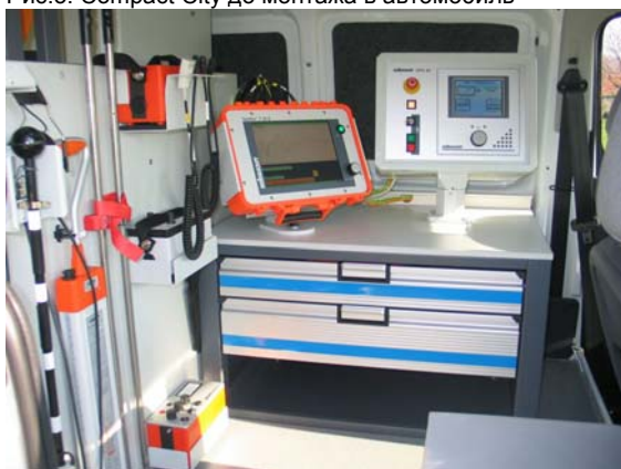
Рис.4. Control-Unit установки SPG 40 и рефлектометр T 30-E
