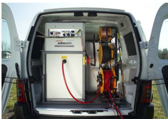
Рис.5. SPG 40 с модулем кабельных барабанов, встроенным в автомобиль Citroen Berlingo
