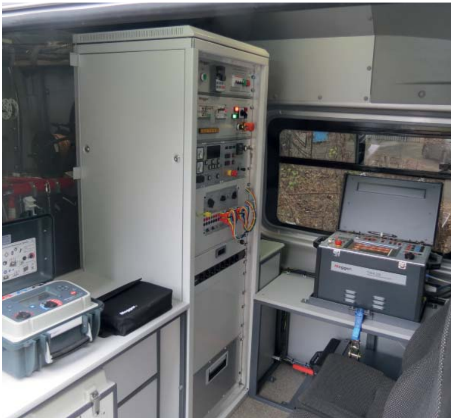
Отсек оператора передвижной лаборатории Astra-Trax производства ООО «Меггер»
